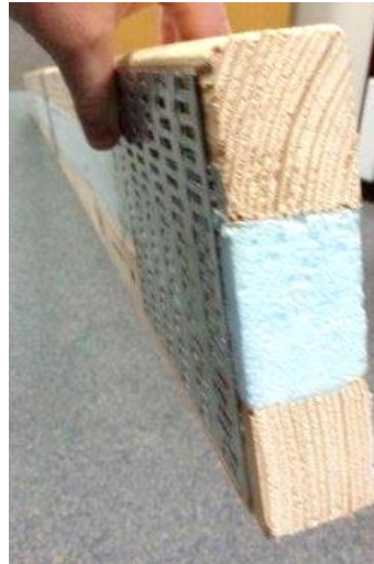
Photo 2: EStud Cross Section
